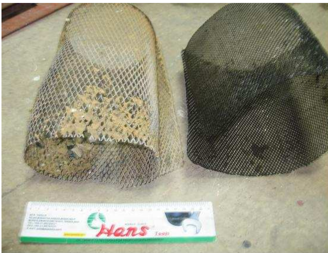
شکل 8- فیلترهای مورد استفاده در صافی مکش پمپ بعد و قبل از استفاده از محلول میتره
