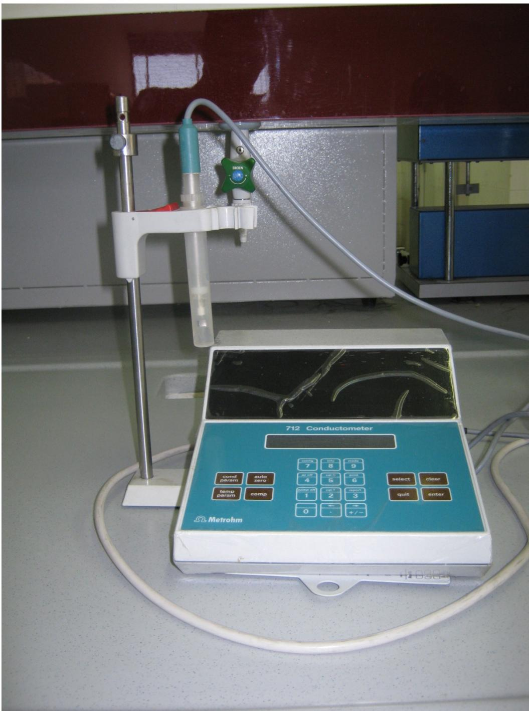
شکل ۲-۳- دستگاه اندازه‌گیری رسانایی
