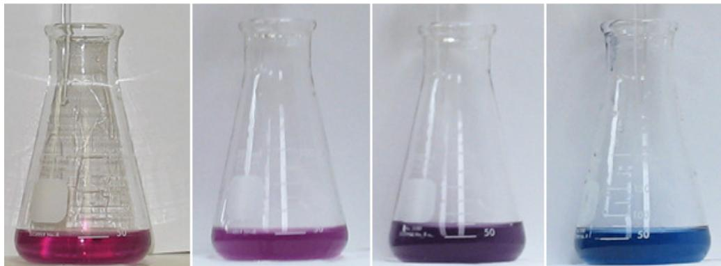
شکل ۷-۲-روند تغییر رنگ محلول در تیتراسیون با EDTA با استفاده از شناساگر Murexide
