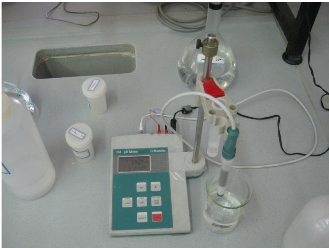
شکل (۴-۲) دستگاه اندازه‌گیری pH
